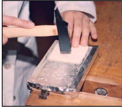
Abb.19: Einbringen der Zinnfolie mit einem Papiertaschentuch und einem Hammer
