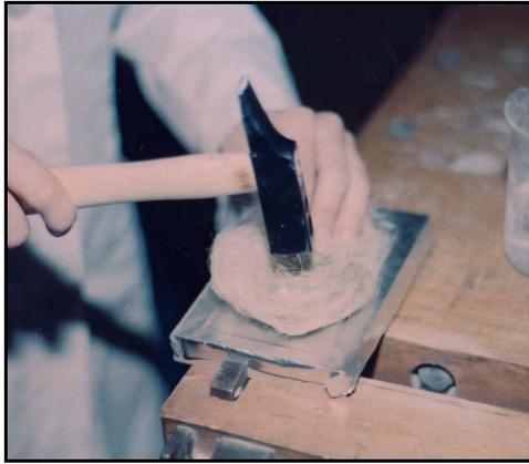
Abb.18: Einbringen der Zinnfolie mit Flachfasern und einem Hammer
