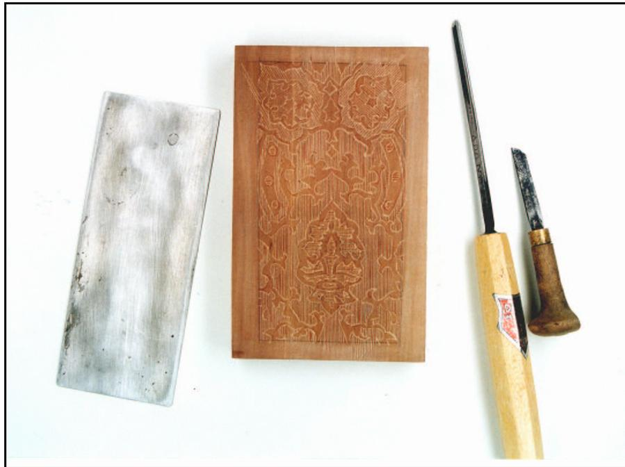
Abb.14: Das Muster wird mit dem Geißfuß geschnitzt und mit dem Bollstichel graviert
